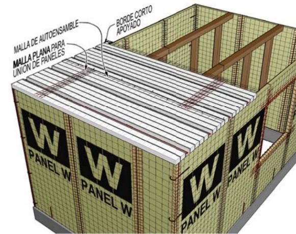
Reforzar todas las uniones entre la losa y los muros con **MALLA L** y con "U" de varilla, de manera similar que al unir muro con muro en esquina, excepto que en los bordes cortos de las hileras en lugar de "U" colocar "L" de varilla de 40x40 cm sobre las nervaduras anclándolas a los muros. Retirar la espuma de la losa en la franja que coincida con los muros de apoyo.
