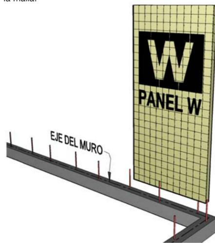
Amarrar los paneles a las anclas con alambre recocado. Unir los paneles entre sí, por ambas caras con **MALLA PLANA** o **ZIG-ZAG**. Las mallas se centran en la unión y se fijan con alambre o grapa, excepto la **ZIG-ZAG** en que se doblan sus puntas para ello. Para muros más altos que el panel colocarlos con cuatrapeo vertical.
