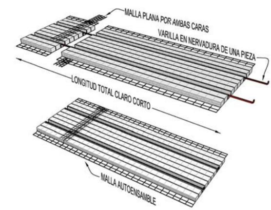
Amarrar con alambre las varillas de modo manteniéndolas sujetas al tercer alambre longitudinal contando de arriba hacia abajo y asegurarse estrictamente que conserven dicha posición.
