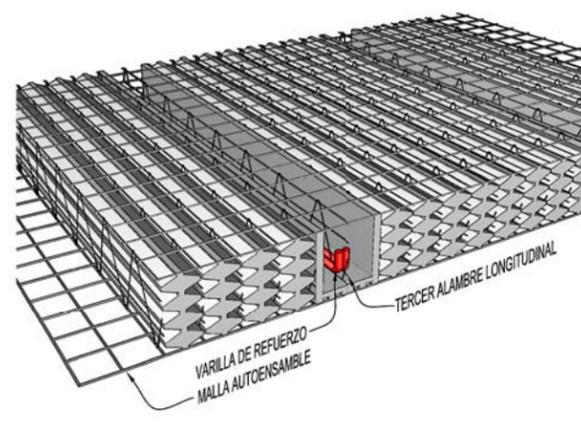
Colocar la hilera orientada de modo que ambos bordes cortos queden apoyados sobre los muros y el lado largo original de los paneles quede en dirección del claro más corto disponible. Colocar la siguiente hilera a un lado, de manera cuatrapeada y amarrar las mallas autoensamblable por ambas caras.
