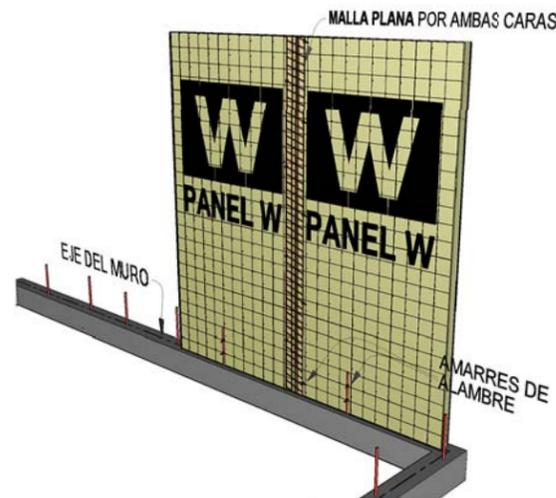
Unir las esquinas con **MALLA L**, reforzándolas con "U" de varilla de  $\frac{3}{8}$ ". Revisar que queden alineados y a plomo, pueden usarse puntales o tensores de alambre para mantener los paneles en su posición.
